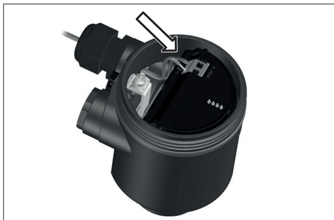
Rys. 20: Czynności przy podłączeniu 5 i 6 - obudowa jednokomorowa
