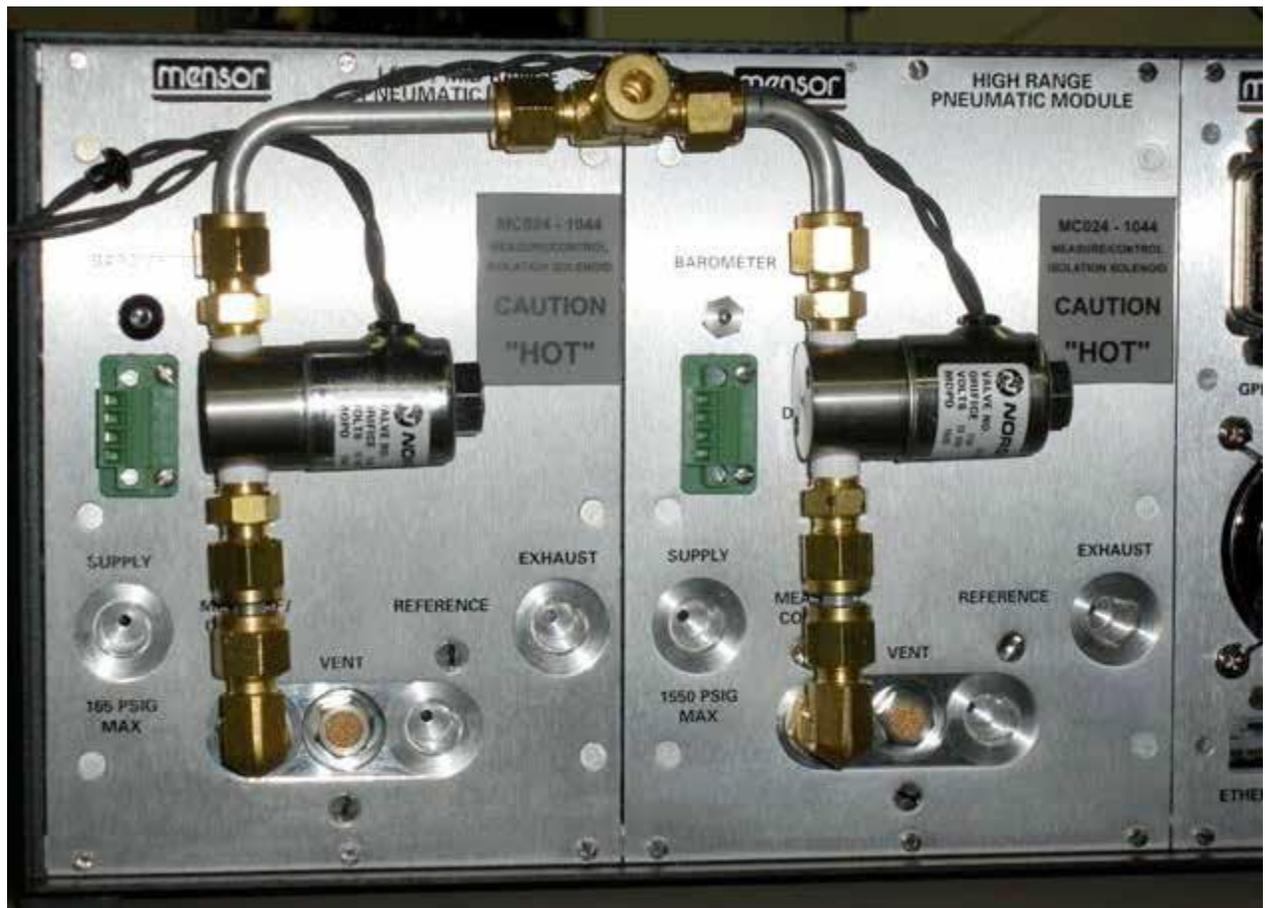
图 8.7 - 双电磁阀单一输出选件的管线后视图演示
