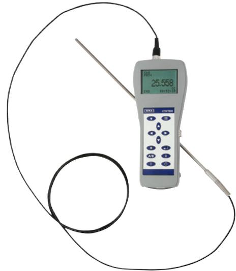
indican tanto ohmios como temperaturas, es ideal incluso para calibración mutua de sensores. En la mayoría de los instrumentos hay que guardar los datos calibrados del sensor en una memoria para optimizar la exactitud de medición, lo que requiere la entrada de gran cantidad de datos en caso de cambio periódico de sensor.
