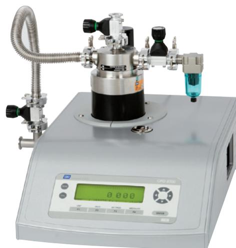
Цифровой манометр CPD8000-AL с модулем для низких давлений
