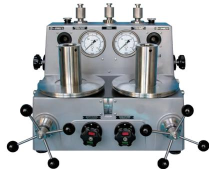
Balanza de presión diferencial, patrón primario, modelo CPB6000DP
