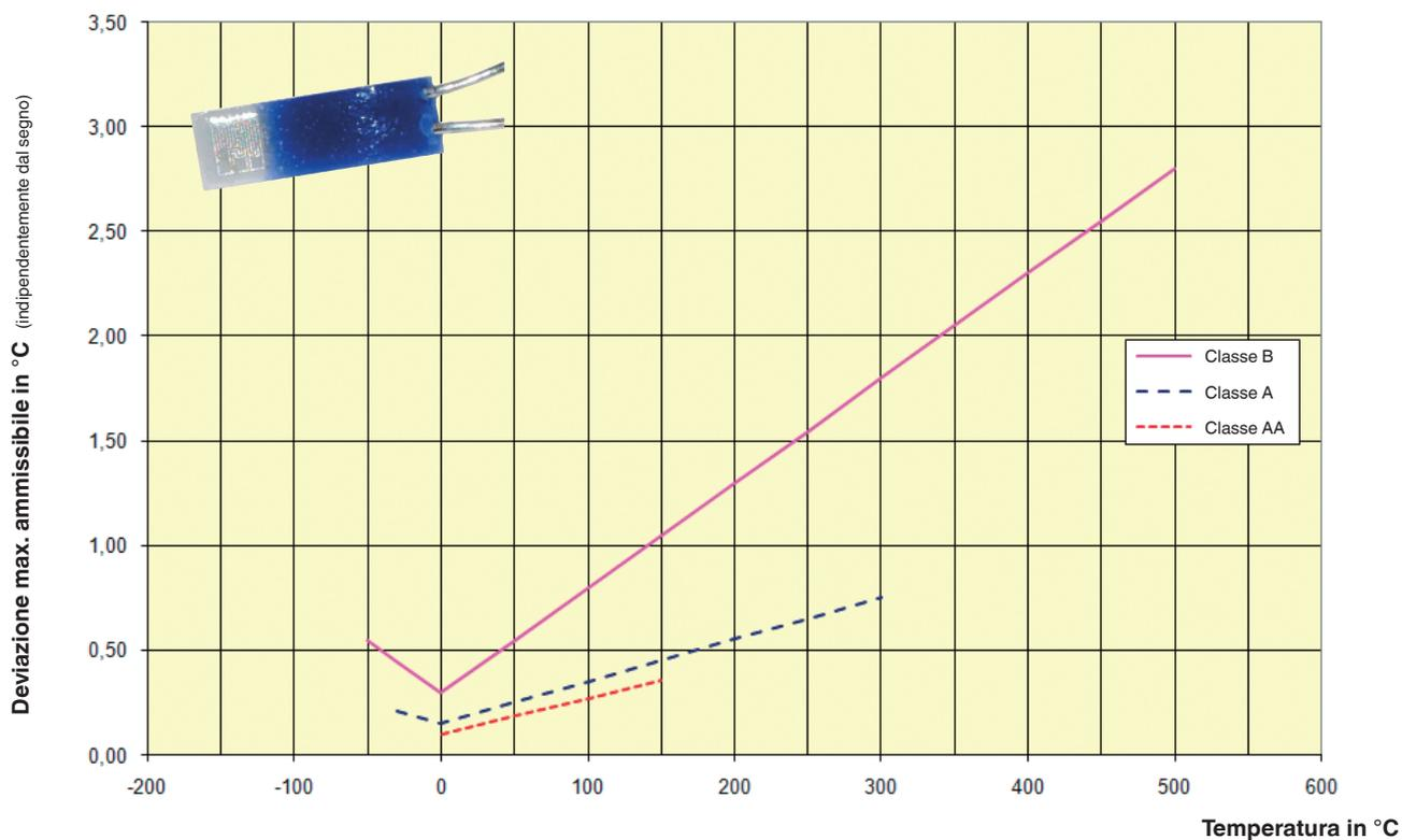
Valore di tolleranza IEC 60751 per le termoresistenze con resistenze di misura a filo avvolto
