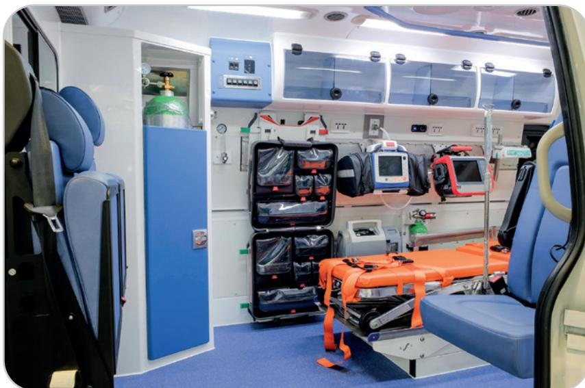
I produttori OEM di ambulanze sono coinvolti nella costruzione di sistemi di fornitura di ossigeno a bordo che devono soddisfare severi requisiti sanitari.
