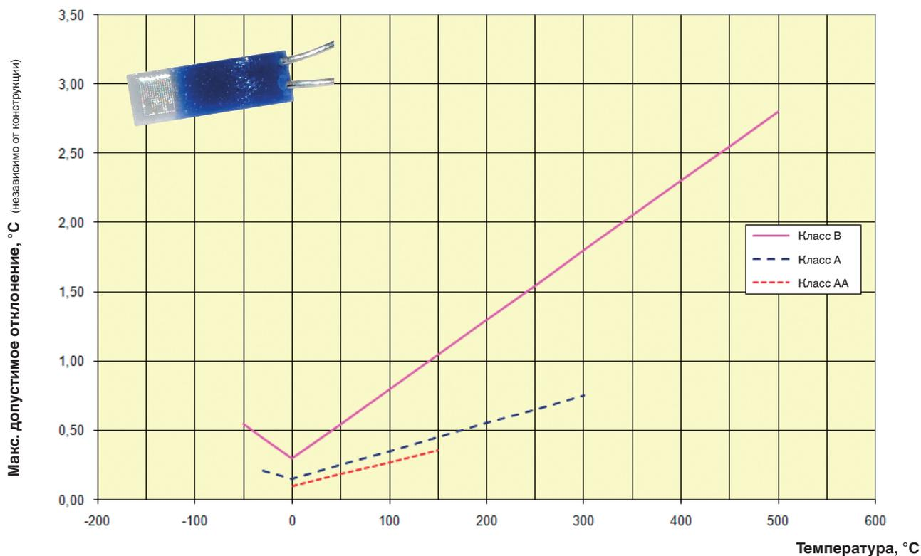
Величина допуска МЭК 60751 для термометров сопротивления с проволочным измерительным резистором
